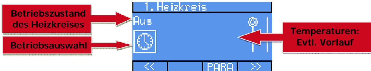
In der Heizkreisübersicht können die Funktion und die Abweichungstemperaturen (Tag und Nacht) der gesamten Anlage mit Hilfe des „Drehrades“ ausgewählt werden!
