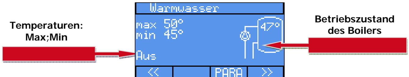
In der Warmwasserübersicht kann durch betätigen der Enter Taste („Rechte Bestätigungstaste“), oder durch drücken des „Drehrades“ das Untermenü Parameter geöffnet werden.
